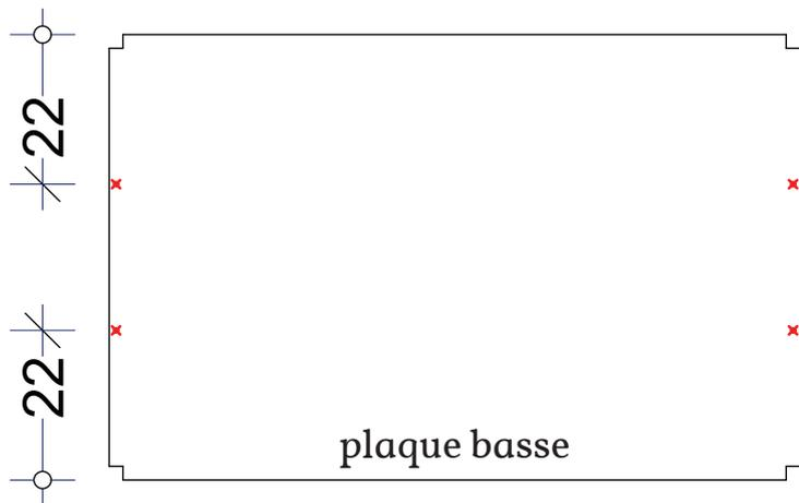
perçage : forets de  $\text{Ø} 7 \text{ mm}$
